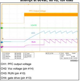
Figure 25. EVL6563S-100W TM PFC: startup
